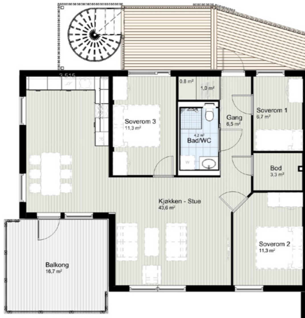
Plantegning for 2.-4. etasje for 4-roms i bygg D. For 1. etasje er det platting istedenfor balkong.
